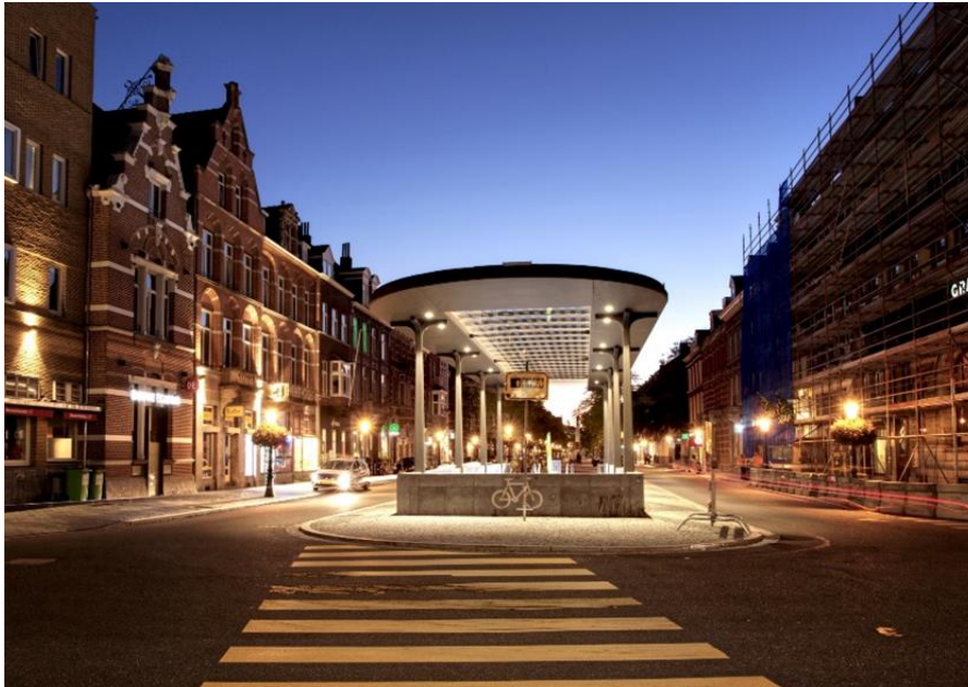
In de Stationsstraat is in 2018 nostalgische verlichting toegepast met unieke vleermuisvriendelijke ledverlichting. De verlichting is gekoppeld aan een telemanagementsysteem.
